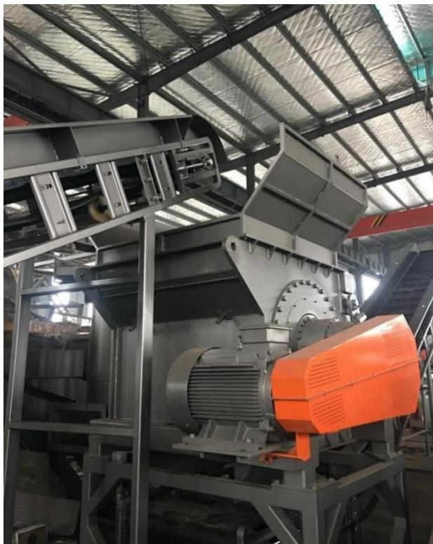
Отсутствие в данном узле **СИТА** также характеризует адаптацию данного узла к сырью полигонного происхождения и гарантирует избежание поломок при попадании различного постороннего мусора.
